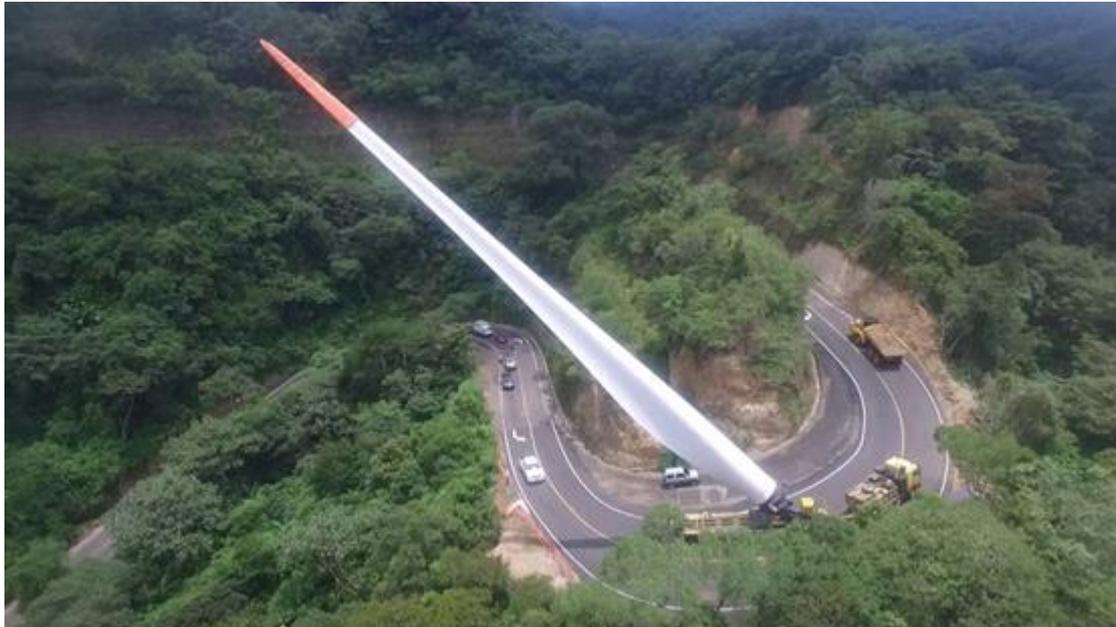
Per effettuare questo cambio di mezzi il Progetto prevede l'utilizzo di una "Area di Trasbordo", a fianco della SS551, poco prima della svolta lungo la SS67, in quanto disponibile un'area coltivata facilmente adattabile.
